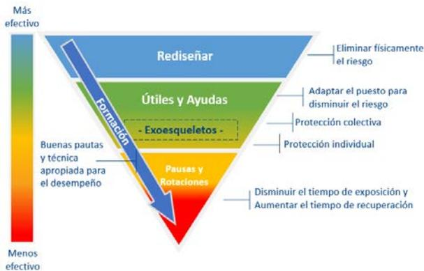
Un exoesqueleto puede considerarse un equipo de trabajo. Por tanto, se trata de una medida de segundo nivel que no debe sustituir a la implantación de medidas técnicas en el origen. Un exoesqueleto es una solución paliativa que no elimina el riesgo.
